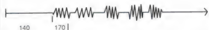
Fig.1 Grafische voorstelling van een vijftooncode signaal. Een compleet 5-TVO signaal duurt ongeveer een halve seconde.
